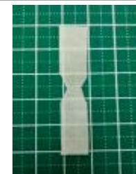
無塵紙にwet30 μm塗布・硬化
