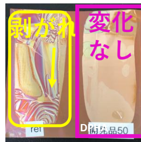
図. 240°C×10分後外観...基材:銅板、wet60μm塗工
