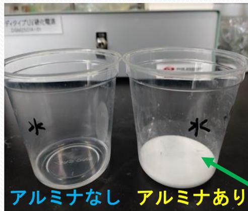
図. 吸水性試験 (12hr)
